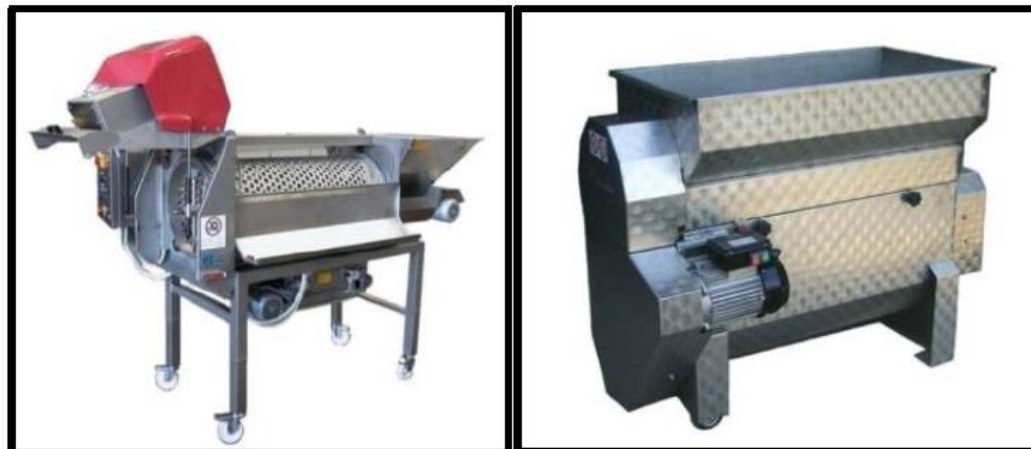
Figure 5 Pigiadiraspatrici costruite in acciaio inox AISI 304.
