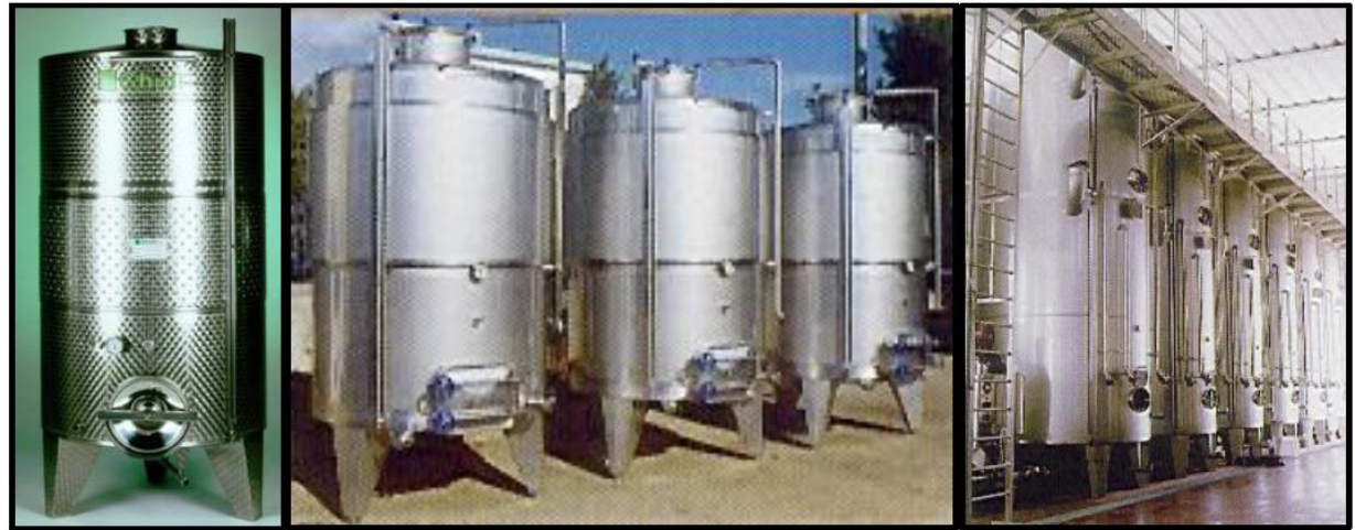
Figura 38 Vinificatori in acciaio inossidabile AISI 304 e AISI 316
