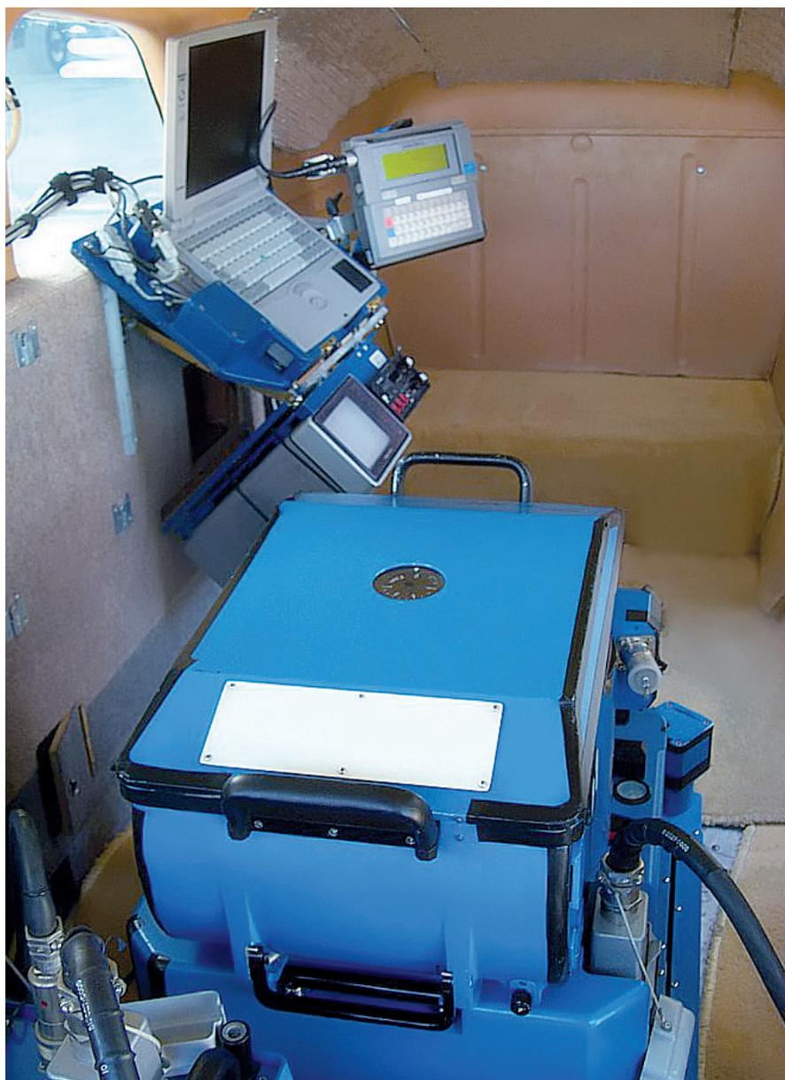
Nella presa aerea la camera viene alloggiata sul pavimento della fusoliera. L'immagine mostra una di queste camere, allestita per le operazioni di presa, già cablata ai dispositivi di controllo e ai portatili con cui viene monitorata costantemente l'evoluzione dell'operazione.
