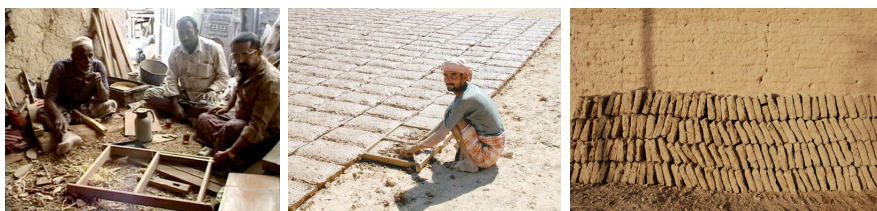
Fig. 3 – A sin. telaio per fare due mattoni di fango; al centro e a destra mattoni di terra-fango ( mudbricks ).
